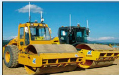
[그림 IV-14] Hitachi 사의 다짐 관리 시스템 36)
