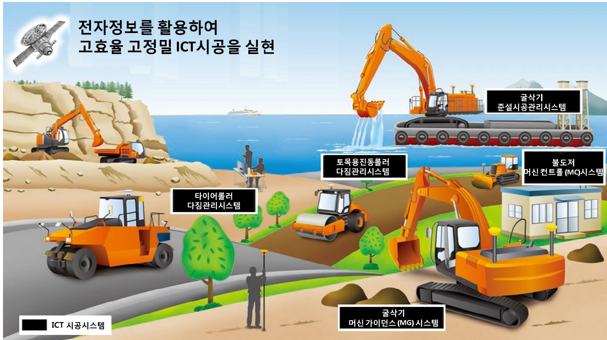
[그림 IV-12] Hitachi 사의 ICT 시공시스템 36)
