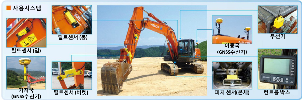
[그림 IV-13] Hitachi 사의 굴삭기 3D 가이드 시스템 36)
